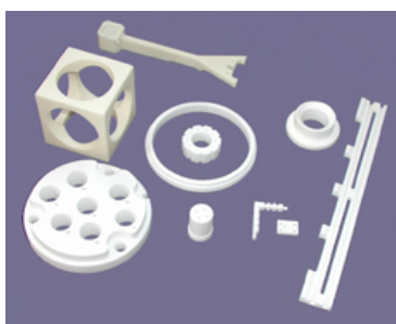
รูปที่ 7 เซรามิกที่มีผลึกนาโนซิลิคอนผสมอยู่ (ภาพจาก http://www.mtec.or.th )
